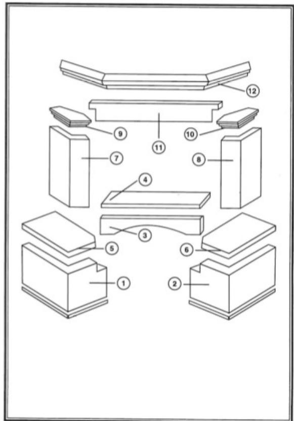
9. В случае использования дополнительной системы распределения горячего воздуха на топке, на боковых плитах необходимо установить боковые опоры облицовки – элементы 7 и 8. Монтируем их таким же самым образом, как и элементы 1 и 2.
