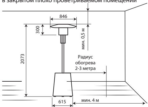
Рис. 1в – Размеры прибора и допуски (0,5 min)
