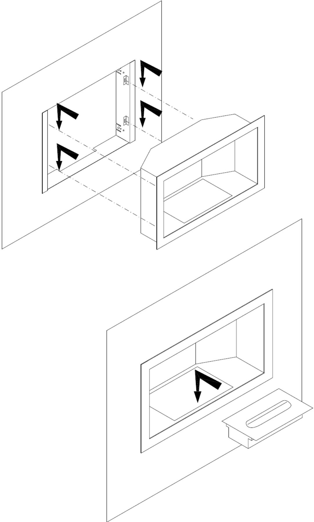
3.5. Установка в стене из кирпича или бетона – см. нижеприведенный чертеж.
