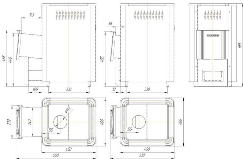
В данной модели печи используется конструкция дверки с навесными петлями расположенными с двух сторон. То есть, дверку можно навешивать с шарнирным соединением, как справа, так и слева. При этом для компенсации люфтов в соединениях при навеске дверки необходимо устанавливать регулировочные шайбы (поставляются в комплекте) согласно схемы.
