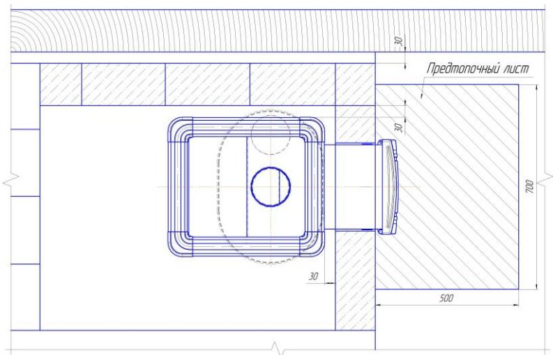
Схема монтажа печи
