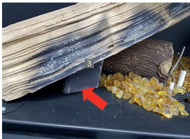
Фото 5: монтаж деталей, этап 2: проследите, чтобы горелка опиралась непосредственно на основание (низ) топки. Между горелкой и основанием топки не должны находиться какие-либо декоративные материалы.
