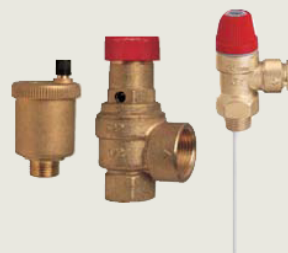
Набор клапанов (421600), состоящий из: автоматического клапана выпуска воздуха, клапана безопасности 1,5 бар, клапана терморегуляции 90°C
